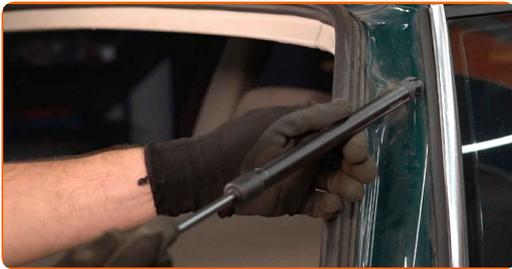
Udskiftning: bagklapsdæmper – VW Passat B5 Variant. AUTODOC eksperter anbefaler:
