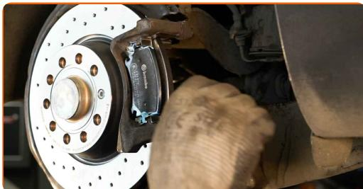
**Udskiftning: bremseklodser – VW Passat Variant B6. Råd fra AUTODOC eksperter:**
