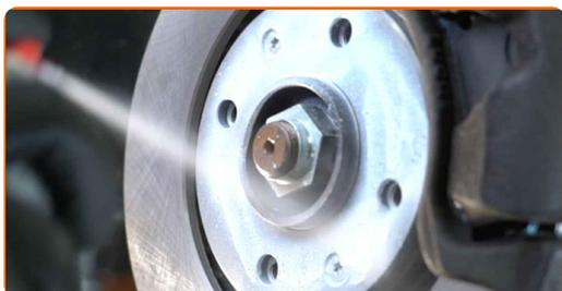
**18** Rengør bremseskivens overflade. Brug bremsrens.
