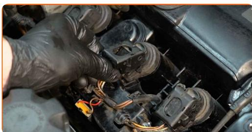
**14** Behandel tændspole forbindelsen med elektrisk kontaktspray. Sprayen vil beskytte mod korrosion og oxidation af de elektriske dele og reducere kontakt modstanden.
