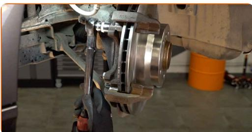
**29** Behandl bremsekaliber cylinder. Brug bremserens.
