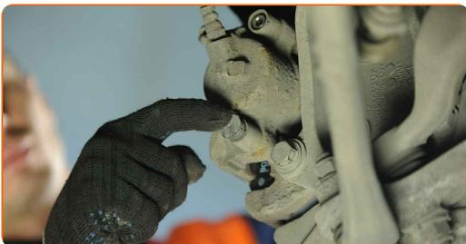
**34** Monter bremsekaliberens holdefjeder. Brug en skruetrækker med lige kærv.
