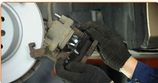
**32** Monter bremsekaliberen og sæt den fast. Brug HEX nr. H7. Brug en momentnøgle. Stram den til 30 Nm moment.
