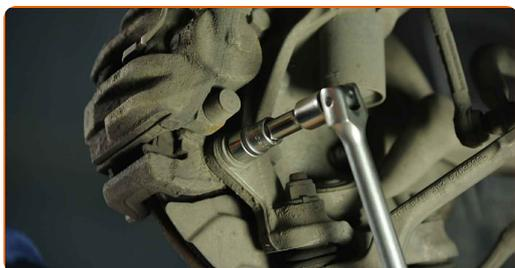
12 Fjern bremsekaliberen.
