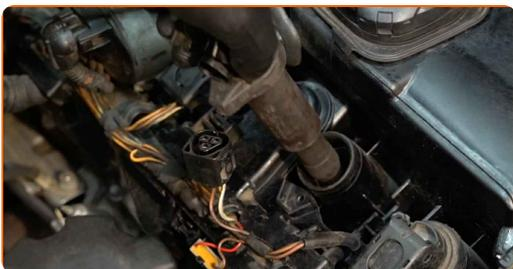
**16** Behandel tændspole spidserne. Brug højtemperatur modstandsdygtig fedt. Brug en skruetrækker med lige kærve.
