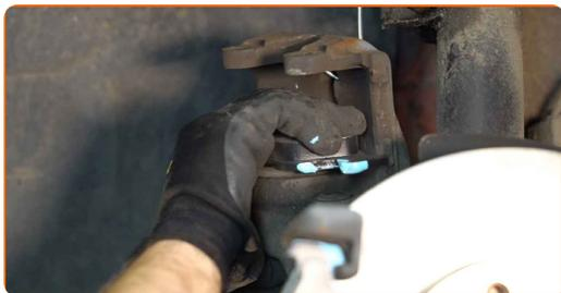
**29** Monter bremsekaliberen og sæt den fast. Brug HEX nr. H7. Brug en momentnøgle. Stram den til 30 Nm moment.
