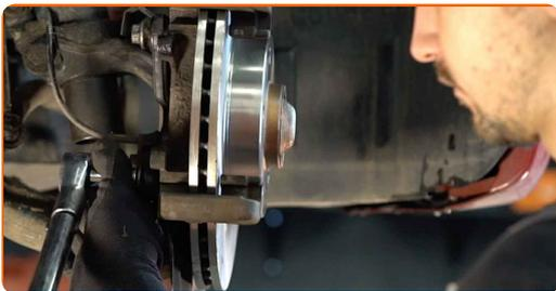
**24** Rengør monteringsstedet af kaliberen og dets bremseåg. Brug en stålbørste. Brug bremserens.
