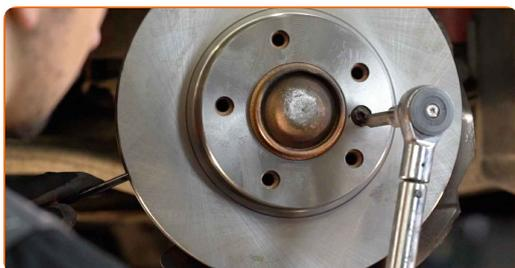
**22** Installer bremsekaliberens beslag.
