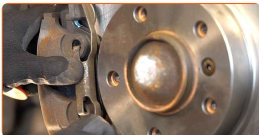
**32** Rengør bremseskivens overflade. Brug bremserens.
