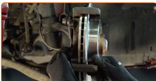
**23** Stram bremsekaliberens beslag. Brug en topnøgle №16. Brug en momentnøgle. Stram den til 110 Nm moment.
