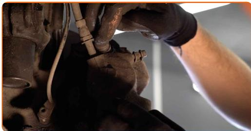
**31** Monter bremsekaliberens holdefjeder.
