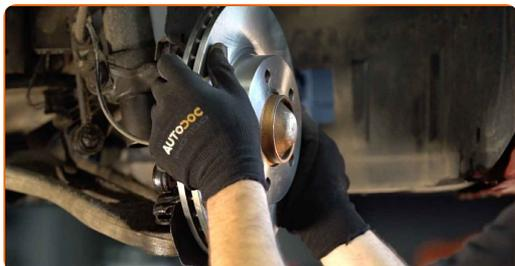
**21** Stram bremseskivens skruer. Brug Torx T30. Brug en momentnøgle. Stram den til 16 Nm moment.
