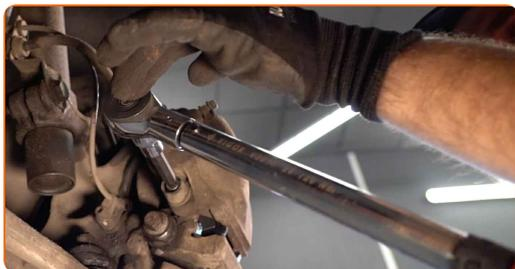
**30** Monter støvhætter på bremsekaliberens styretapper.
