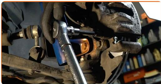
**21** Monter støvhætter på bremsekaliberens styretapper.
