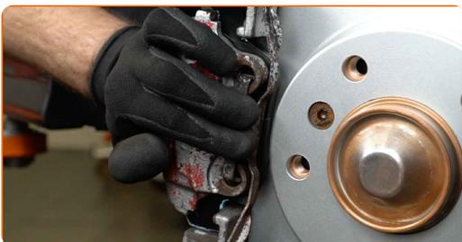
**20** Stram bremskaliber befæstigelse. Brug HEX nr. H7. Brug en momentnøgle. Stram den til 30 Nm moment.
