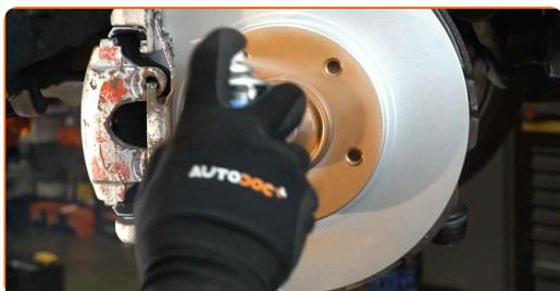
**23** Rengør bremseklodsens overflade. Brug bremserens.
