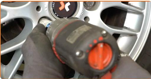
21 Sænk bilen og stram hjulboltene på kryds med. Brug hjul slagnøgle #17. Brug en momentnøgle. Stram den til 120 Nm moment.
