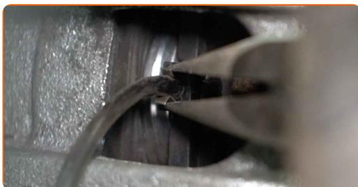
12 Tilslut kablet til bremseklods slidsensor.
