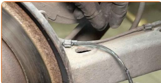
13 Benhandel bremseklods slidsensor proppen. Brug dielektrisk fedt.
