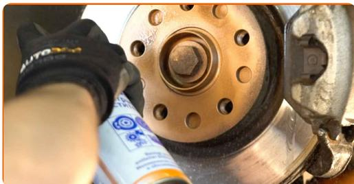
**32** Rengør bremseskivens overflade. Brug bremsrens.
