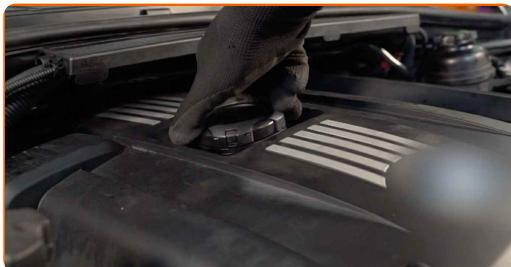
**33** Tænd motoren og lad den køre i nogle minutter. Efter at olietryks advarselslampen er gået ud, stop motoren.
