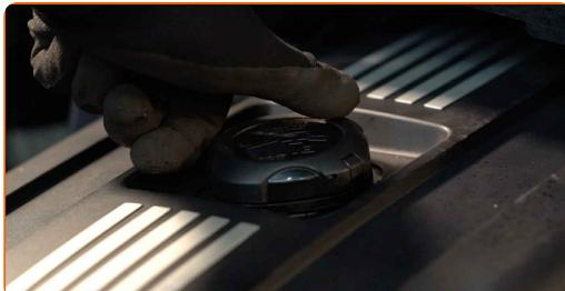
**4** Skru filterhusets dæksel af sammen med det gamle oliefilter element. Brug 86-16F spændenøgle. Brug en skraldenøgle.
