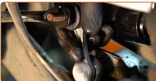
**12** Spænd stabiliseringsstiverens fastgørelse til. Brug en kombinøgle № 16. Brug en topnøgle №17. Brug en skraldenøgle.
