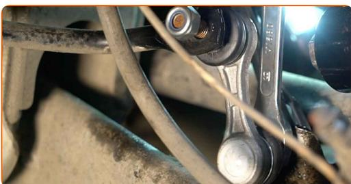
**13** Spænd befæstigelsen til der forbinder forbindelsesstangen med krængningsstabilisatoren. Brug en topnøgle №17. Brug en momentnøgle. Stram den til 60 Nm moment.
