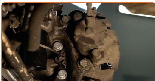
**33** Monter bremsekaliberens holdefjeder.
