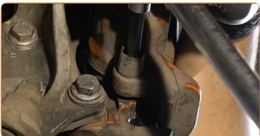
**22** Monter støvhætter på bremsekaliberens styretapper.
