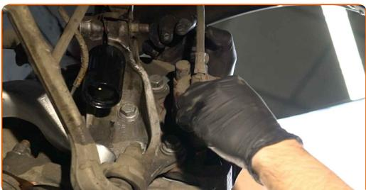
**23** Monter bremsekaliberens holdefjeder.
