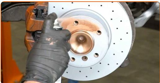
**25** Rengør bremseklodsernes overflade. Brug bremserens.
