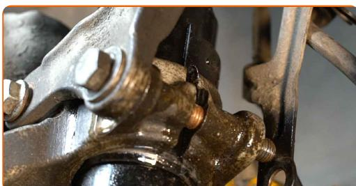
**35** Skru fastgørelsen ind som forbinder fjederbenet med styrekuglen. Brug en kombinøgle № 18. Brug en topnøgle №18. Brug en skraldenøgle.
