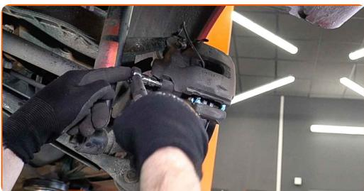
**20** Monter støvhætter på bremsekaliberens styretapper.
