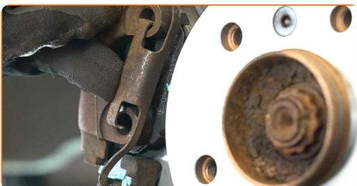
**22** Rengør bremseskivens overflade. Brug bremserens.
