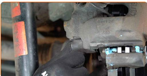
**21** Monter bremsekaliberens holdefjeder.
