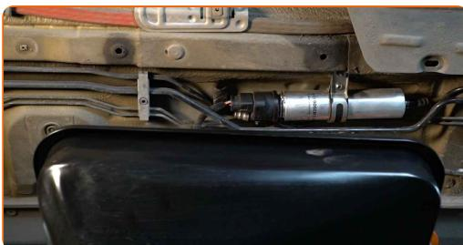
**3** Fjern låsenringen til brændstoftrykregulator låseclips. Brug en skruetrækker med lige kærv.
