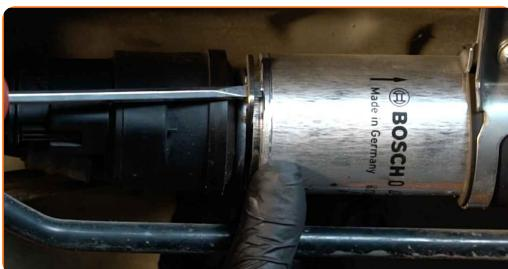
**4** Fjern spændclips fra brændstoffilter røret. Brug en skruetrækker med lige kærv.
