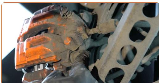
**24** Tilslut bremseklodsernes slidsensor.
