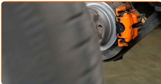
10 Tag bremseklodsens slidsensor af. Brug et koben.
