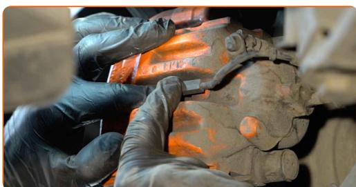
**25** Monter bremsekaliberens holdefjeder.
