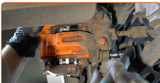
**23** Monter støvhætter på bremsekaliberens styretapper.
