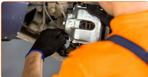
**22** Løsen bremseudlufningsskruen. Brug en kombinøgle № 9.
