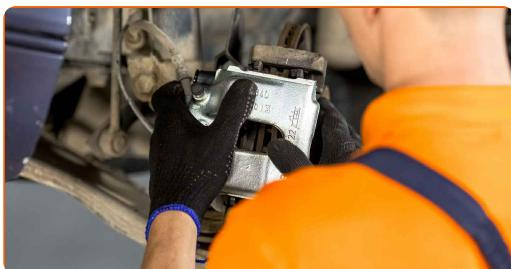
**21** Monter støvhætter på bremsekaliberens styretapper.
