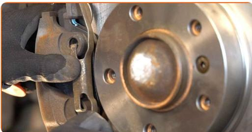
21 Rengør bremsekivens overflade. Brug bremserens.
