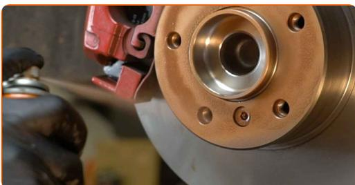
**36** Rengør bremsekladdens overflade. Brug bremserens.
