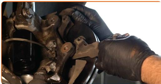
**29** Stram bremsekaliberens beslag. Brug en topnøgle N°18. Brug en momentnøgle. Stram den til 110 Nm moment.
