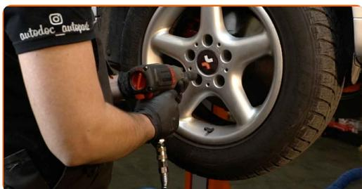
**39** Sænk bilen og stram hjulboltene på kryds med. Brug hjul slagnøgle #17. Brug en momentnøgle. Stram den til 120 Nm moment.
