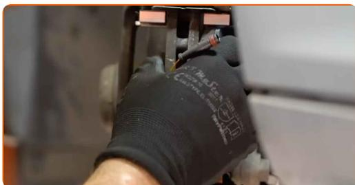
29 Installer bremseslangen på den nye bremskaliber.
