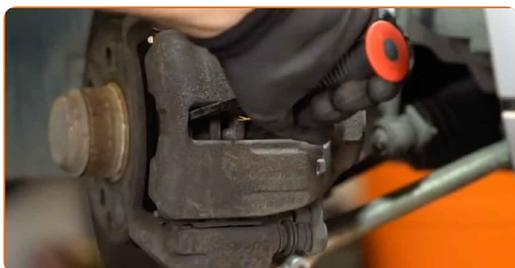
15 Fjern bremsekaliberen.
