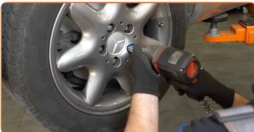
**32** Sænk bilen og stram hjulboltene på kryds med. Brug hjul slag nøgle #17. Brug en momentnøgle. Stram den til 110 Nm moment.
