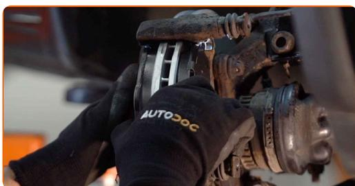
**27** Monter bremsekaliberen og sæt den fast.
