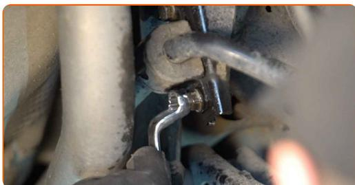
**10** Skru befæstelsen af, der forbinder sportstangen med krængningsstabilisatoren. Brug en kombinøgle N° 15. Brug en topnøgle N°15. Brug en skraldenøgle.
