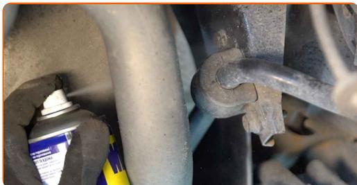
**9** Løsen befæstelserne til stabiliseringsbøsning beslagene. Brug en kombinøgle N° 15. Brug en topnøgle N°15.
