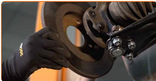
**18** Rengør navet. Brug en stålbørste. Behandl kontaktfladen. Brug kobberfedt.
