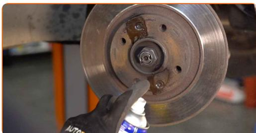
**16** Skru bremseskivens skrue af. Brug Torx T30. Brug en slagskruetrækker.
