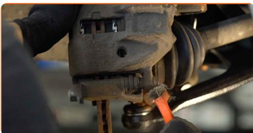
**8** Skru kaliberens skruer af. Brug en kombinøgle N°13. Brug en kombinøgle N°15.
