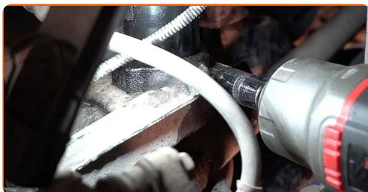
**58** Skru befæstigelsen der forbinder kugleledet til styrespindlen. Brug en topnøgle N°16. Brug en topnøgle N°18. Brug en skraldenøgle.
