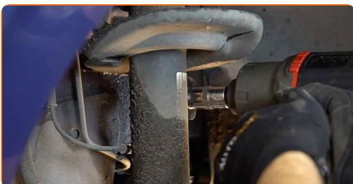
**16** Rengør befæstelserne der forbinder fjederbenet til stubakslen. Brug en stålbørste. Brug WD-40 spray.
