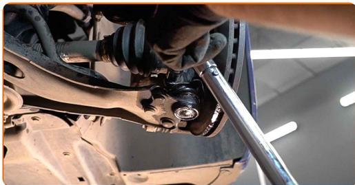
**66** Spænd befæstigelsen til der forbinder forbindelsesstangen med fjederbenet. Brug en topnøgle N°16. Brug en momentnøgle. Stram den til 43 Nm moment.
