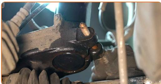
**57** Installer og spænd den nye bolt på styrespindlen.
