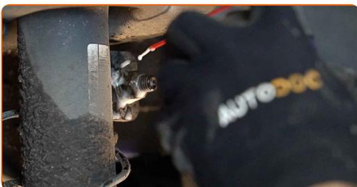
**15** Skru møtrikken af og fjern stabilisatorstangen fra fjederbenet. Brug en topnøgle N°16.
