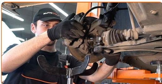
**30** Frigør den nedre befæstigelse der forbinder fjederbenet til stubakslen. Brug særlige skiftenøgler for at fjerne støddæmperen. Brug en skraldenøgle.
