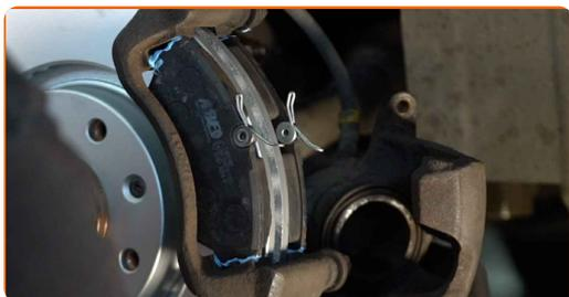
**27** Monter bremsekaliberen og sæt den fast. Brug en kombinøgle N° 13. Brug en kombinøgle N° 15. Brug en momentnøgle. Stram den til 27 Nm moment.
