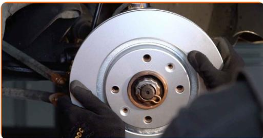
**20** Stram bremseskivens skruer. Brug en Phillips skruetrækker. Brug en momentnøgle. Stram den til 9 Nm moment.
