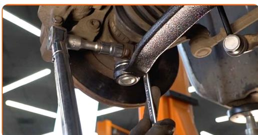
**27** Støt armen. Brug en hydraulisk løfteenhed.
