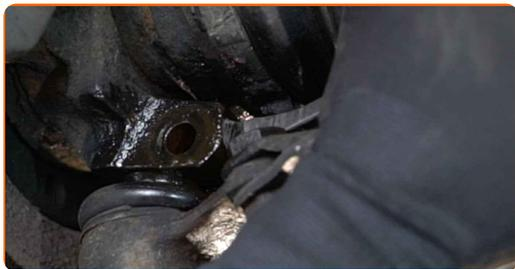
**30** Tag kugleledet af styrekuglen. Brug et koben.
