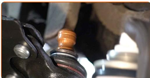
**66** Frigør befæstigelsesne som forbinder bæreamens styrekugle til styrespindlen. Brug en flad metalmejsel. Brug en hammer.
