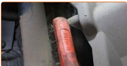
**11** Løsen befæstigelsen af forbindelsen mellem forbindelstangen og fjederbenet. Brug en topnøgle N°17. Brug en skraldenøgle.
