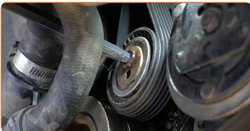
**13** Træk poly V-rem remstrammeren til side. Brug en 1/4" firkantforlænger. Brug en skraldenøgle.
