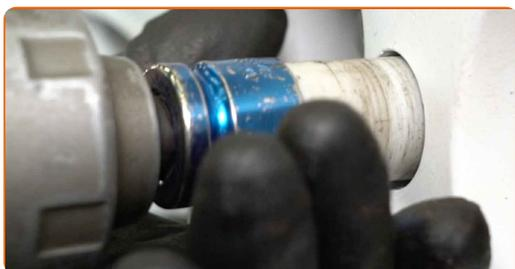
**51** Sænk bilen og stram hjulboltene på kryds med. Brug hjul slagnøgle #17. Brug en momentnøgle. Stram den til 110 Nm moment.
