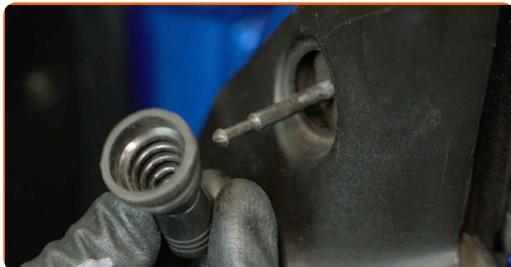
**4** Frigør sidespejl afdækningspanel. Brug en plastik klipsptang.
