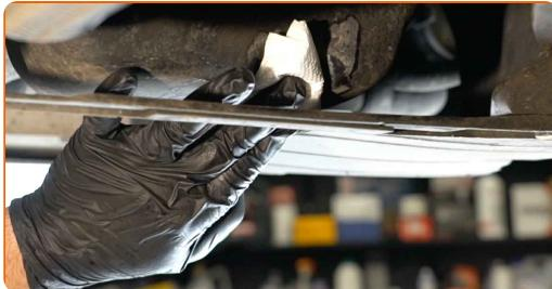
**31** Skru den nye bundskrue ind i og stram til. Brug Torx T45. Brug en momentnøgle. Stram den til 20 Nm moment.
