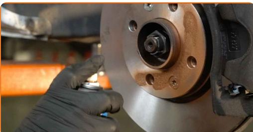
**21** Rengør bremseskivens overflade. Brug bremserens.
