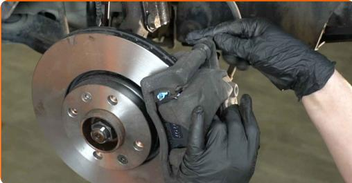
**20** Behandle overfladen hvor bremseskiven har kontaktflade til hjulnavet. Brug kobberfedt.
