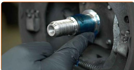
**18** Installer bremsetromlens samling med hjulnavlejet.
