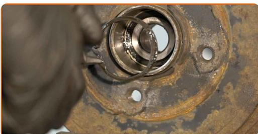
**12** Pres hjulnavets leje ud. Brug et bøsningss-/ og lejeaftrækkersæt.
