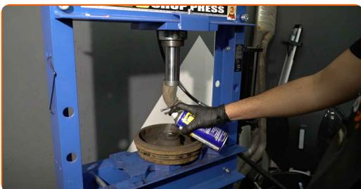
**14** Tryk det nye hjulnav leje ind i bremsetromlen. Brug et bøsningss-/ og lejeaftrækkersæt.
