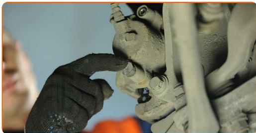
**21** Monter bremsekaliberens holdefjeder. Brug en skruetrækker med lige kærve.
