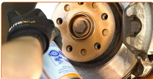
**23** Rengør bremseklodsens overflade. Brug bremserens.
