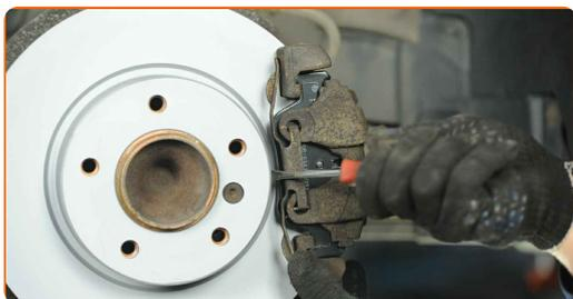
**22** Behandle overfladen hvor bremseklodsen har kontaktflade til hjulnavet. Brug kobberfedt.
