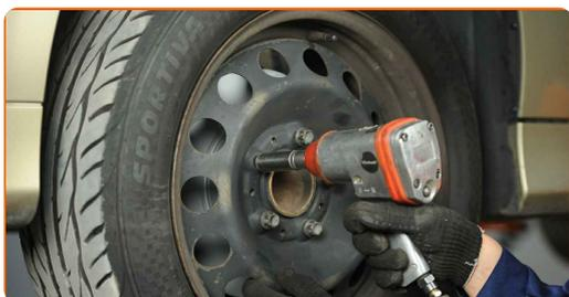
**26** Sænk bilen og stram hjulboltene på kryds med. Brug hjul slagnøgle #17. Brug en momentnøgle. Stram den til 120 Nm moment.
