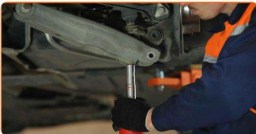
**19** Stram den nedre fastgørelse på støddæmperen. Brug en topnøgle N°E12. Brug en momentnøgle. Stram den til 47 Nm moment.
