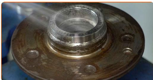
**27** Monter de nye hjullejeres yderringe. Brug et bøsning-/ og lejeaftrækker sæt.
