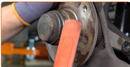
**18** Fjern hjulnav kapsel. Brug et koben.
