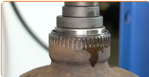
**26** Rens hjullejernes monteringsæder. Brug universal rengøringsmiddel.
