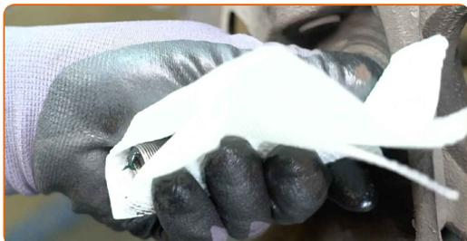
**23** Rengør ABS-sensoren. Brug en nylon rengøringsbørste. Brug universal rengøringsmiddel.
