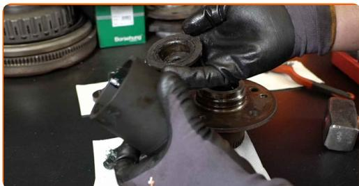
**25** Afmonter de ydre ringe i hjullejerne. Brug et bøsning-/ og lejeaftrækker sæt. Brug en universal aftrækker.
