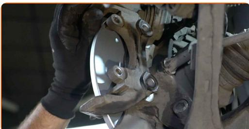
**30** Stram bremsekaliberens beslag. Brug en topnøgle №19. Brug en momentnøgle. Stram den til 115 Nm moment.
