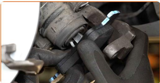
**33** Monter bremsekaliberen og sæt den fast. Brug HEX nr. H7. Brug en momentnøgle. Stram den til 28 Nm moment.
