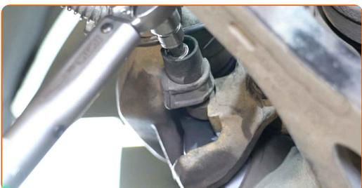
**34** Monter støvhætter på bremsekaliberens styretapper.
