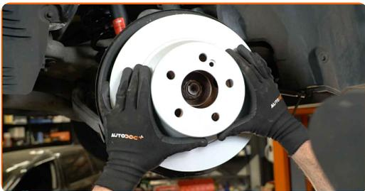
27 Stram bremseskivens skruer. Brug Torx T30. Brug en momentnøgle. Stram den til 8 Nm moment.
