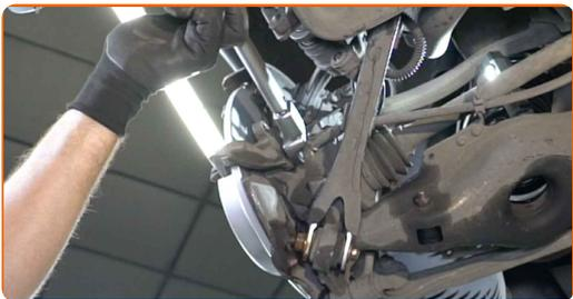
**31** Tryk bremsekaliberens stempel ind. Brug bremsestempelværktøj.
