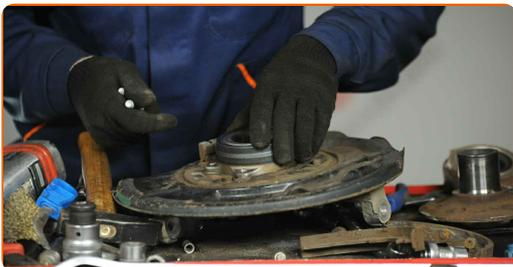
**48** Stram befæstigelsen til på hjulnav lejet. Brug en topnøgle N°E12. Brug en momentnøgle. Stram den til 80 Nm moment.
