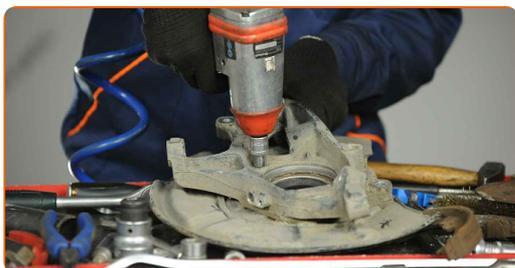
**45** Fjern navlejets beslag. Brug en hammer.
