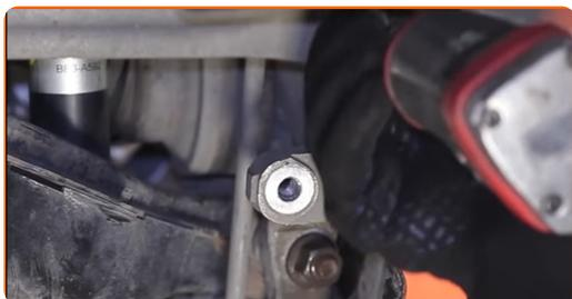
**23** Rens krængningsstabilisatorens befæstigelser. Brug en stålbørste. Brug WD-40 spray.
