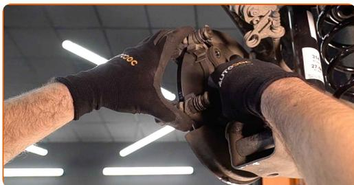
**22** Stram bremsekaliberens beslag. Brug en topnøgle №17. Brug en momentnøgle. Stram den til 62 Nm moment.
