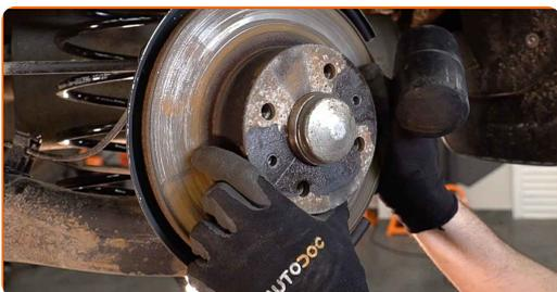
**17** Rengør navet. Brug en stålbørste. Behandl kontakfladen. Brug kobberfedt.
