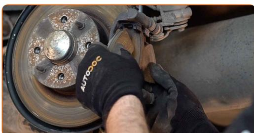
**11** Rengør bremsekaliberen befæstigelse. Brug en stålbørste. Brug WD-40 spray.
