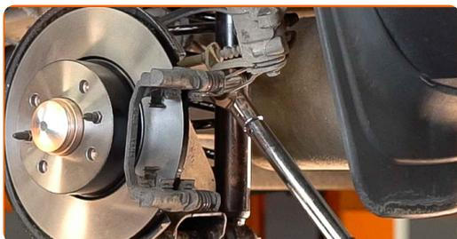
**23** Behandel bremsekaliber cylinder. Brug bremserens.
