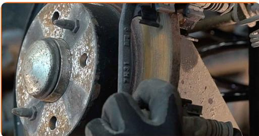
**14** Rengør bremsekivebefæstigelsen. Brug en stålbørste. Brug WD-40 spray.
