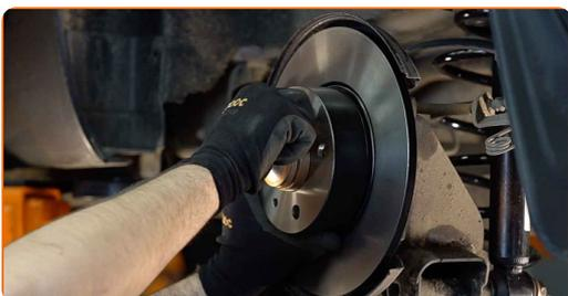
**19** Stram bremseskivens skruer. Brug en topnøgle N°12. Brug en momentnøgle. Stram den til 10 Nm moment.
