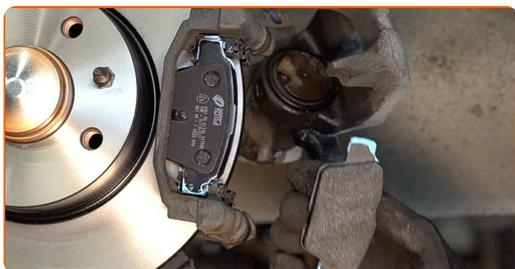
**30** Monter bremsekaliberen og sæt den fast. Brug en topnøgle №13. Brug en momentnøgle. Stram den til 30 Nm moment.
