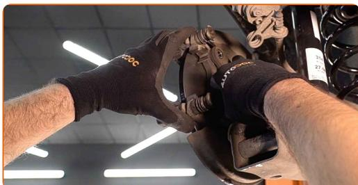
**28** Stram bremsekaliberens beslag. Brug en topnøgle №17. Brug en momentnøgle. Stram den til 62 Nm moment.
