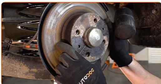
**16** Fjern hjullejets beskyttelseshætte. Brug et koben. Brug en hammer.
