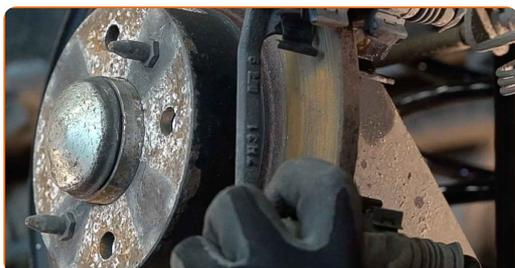
**13** Rengør bremseskivebefæstigelsen. Brug en stålbørste. Brug WD-40 spray.
