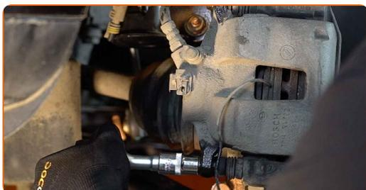
**11** Fjern bremsekaliberen.
