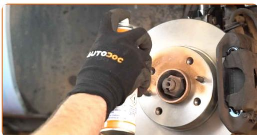
**19** Rengør bremseskivens overflade. Brug bremsrens.
