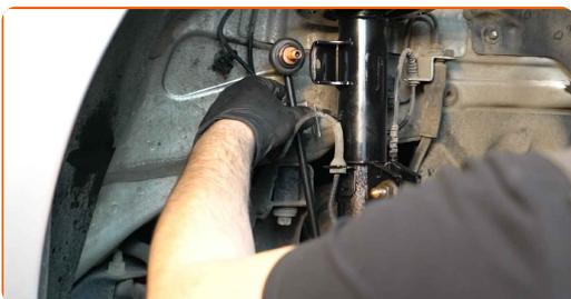
**12** Spænd befæstigelsen til der forbinder forbindelsesstangen med fjederbenet. Brug en topnøgle №17. Brug en momentnøgle. Stram den til 50 Nm moment.
