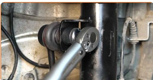
**13** Spænd befæstigelsen til der forbinder forbindelsesstangen med krængningsstabilisatoren. Brug en topnøgle №17. Brug en momentnøgle. Stram den til 50 Nm moment.
