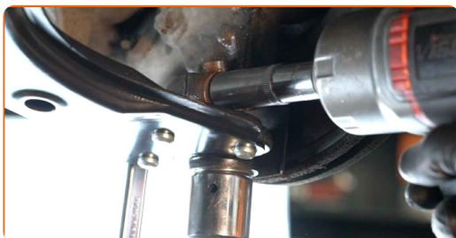
**23** Skru den bageste befæstigelse fast der forbinder bærearmeren med underrammen. Brug en kombinøgle N° 18. Brug en topnøgle N°E18. Brug en skraldenøgle.
