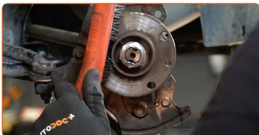
**20** Rengør bremseskivens overflade. Brug universal rengøringsmiddel.
