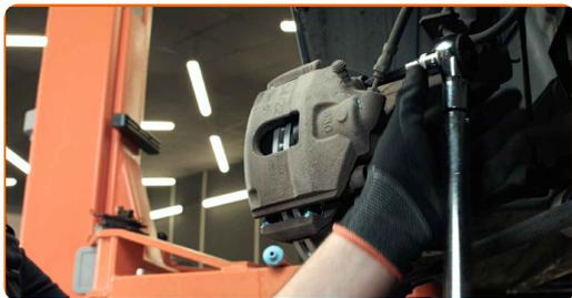
**19** Monter støvhætter på bremsekaliberens styretapper.
