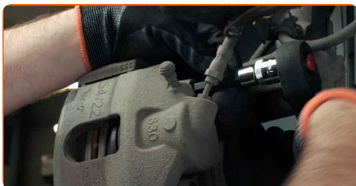
**10** Løsgør bremsekaliber låsefjeder. Brug et koben.
